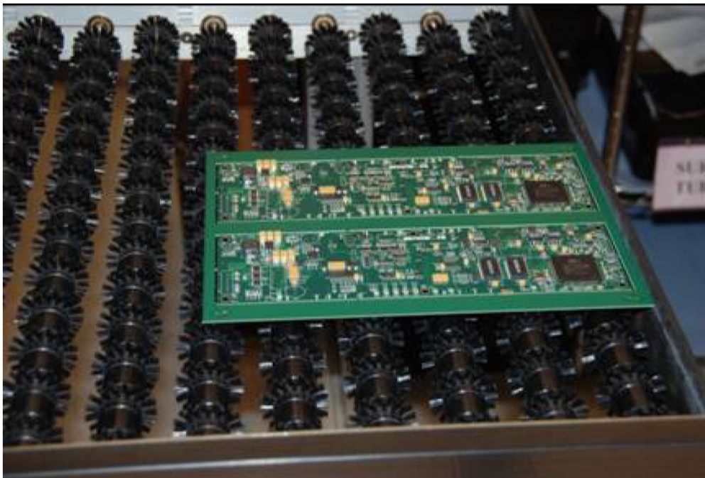
図 28. 制御なしのブラシは、基板上に 500V を越える電圧を発生する
