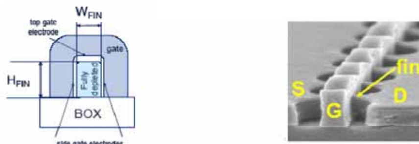
図 17. 最新の FinFET の断面図
